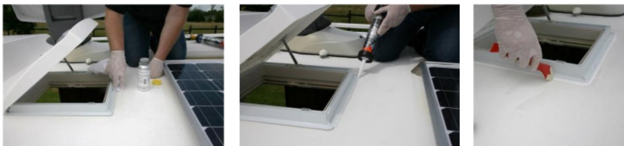
Dégraissage au Sika Aktivator-205, Application du Sikaflex-512 Caravan, Lissage du joint : *se reporter au Pas à Pas « Faire une étanchéité périphérique du lanterneau en 3 étapes ».*
