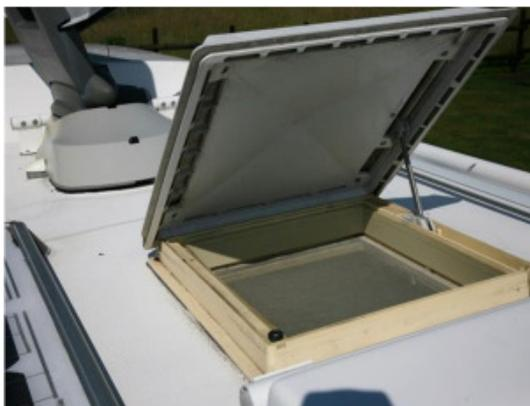
Une étanchéité détériorée au niveau du lanterneau est source de gros dégâts endommageant la structure de l'habitacle. Il est important de vérifier au bon état de son étanchéité : il convient de refaire l'étanchéité régulièrement ou de changer un lanterneau trop abimé.
